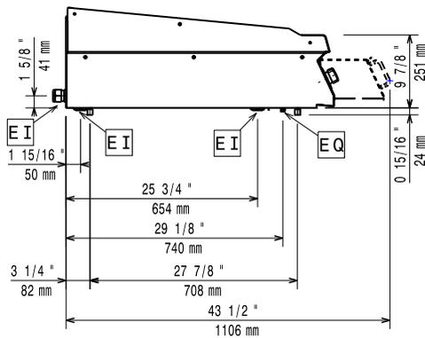
EI = Conexión eléctrica (energía)
